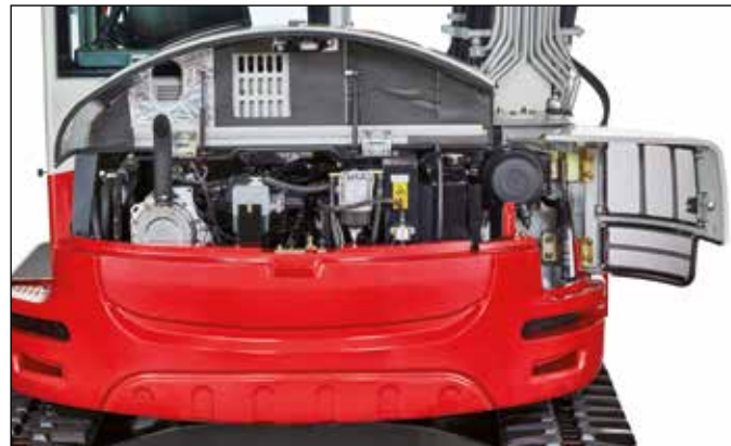
Motores con niveles reducidos de consumo, ruidos y emisiones de gases, tubo de escape hacia arriba; contrapeso macizo.
