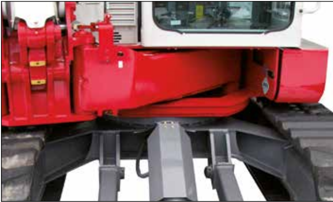
Robusta traslación lateral del brazo, patentado por TAKEUCHI.
